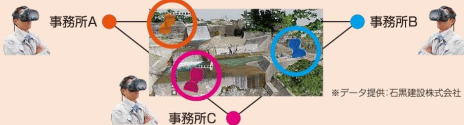
VR空間では、施工協議を円滑に進めるための「距離や面積、座標の計測」、「写真撮影」、「施工機械のアニメーション」などが実施できます。
