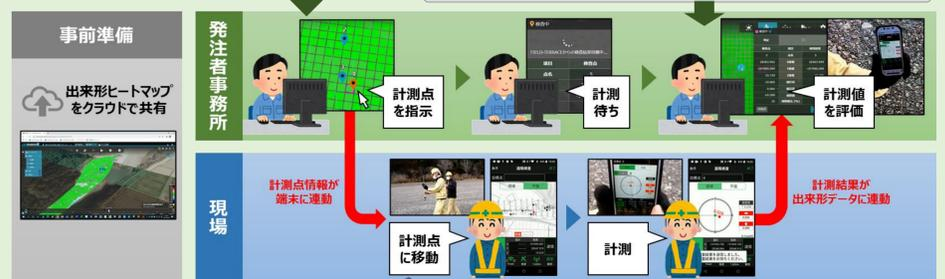
手順②：受注者が現場計測アプリで計測箇所を確認・計測
